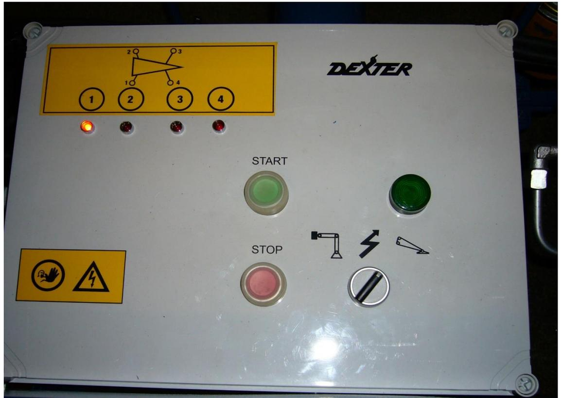
Die rote Kontrollleuchte erlischt an jedem Stützbein, wenn der Ausleger-Endschalter greift ein. Wenn alle vier roten Kontrollleuchten ausgeschaltet, die grüne Kontrollleuchte der Stützfüße leuchtet auf und die Arbeitsplatte wird angehoben möglich.
