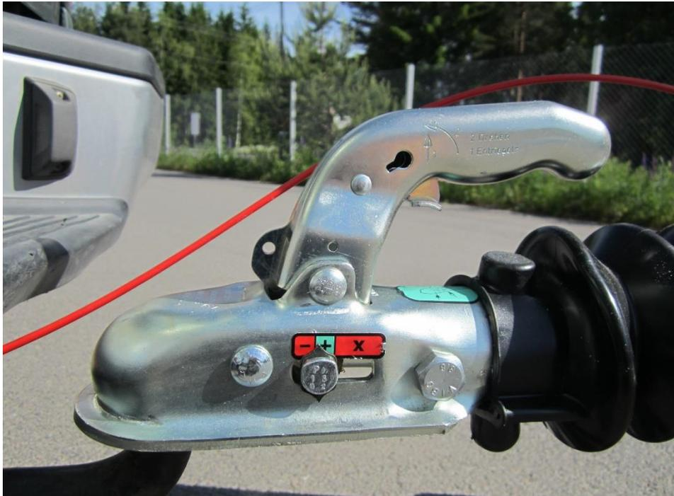
Wenn die Kugelkupplung mit der Kugelkupplung verriegelt ist, muss sich der Zeiger der Schlosskontrollanzeige im grün markierten + / OK-Bereich befinden.
