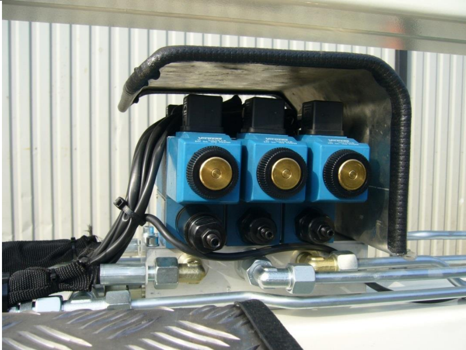
Figur 2: Övertrycksventil i ventilenheten på den nedre bommen.
