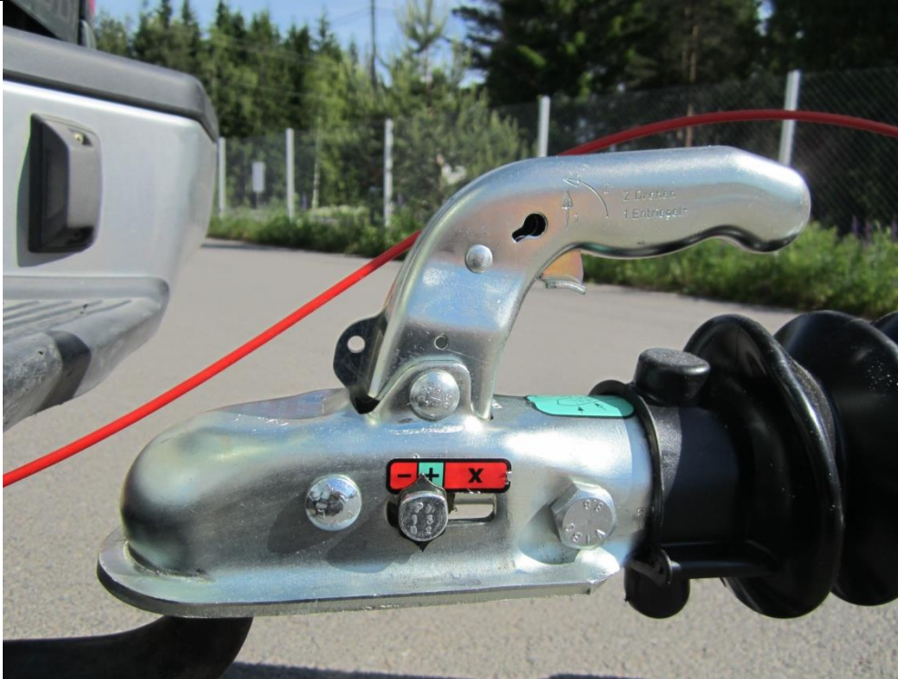
Bild 1: När kulkopplingen är låst i dragkulan, ska pekaren för låskontrollindikatorn vara i det grönmarkerade +/OK- området.
